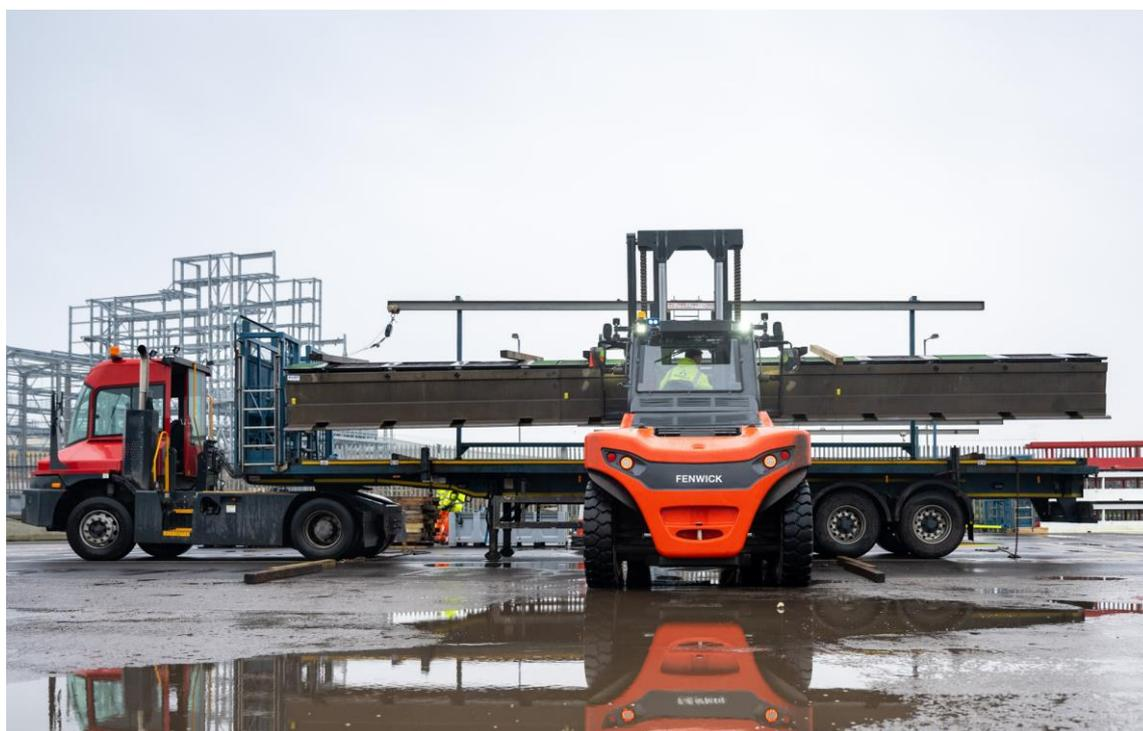
**Fenwick-Linde propose désormais une nouvelle gamme de chariots élévateurs électriques pour charges lourdes, dont la capacité de charge est comprise entre 10 et 18 tonnes. Douze modèles au total font forte impression de par leur excellente visibilité panoramique, et offrent un maximum de flexibilité grâce à tout un panel de systèmes de batteries au plomb ou au lithium-ion.**
